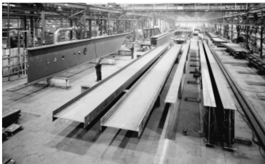
Les usines Canam transforment l'acier en le découpant, le pliant et le soudant. Ci-dessus, l'usine de Canam-Structal à Québec.
